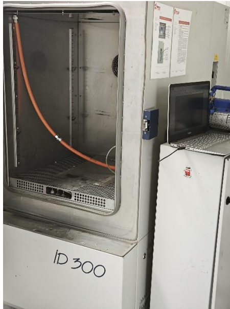
Şekil 1. Vakum altında sızdırmazlık deneyi sistemi
