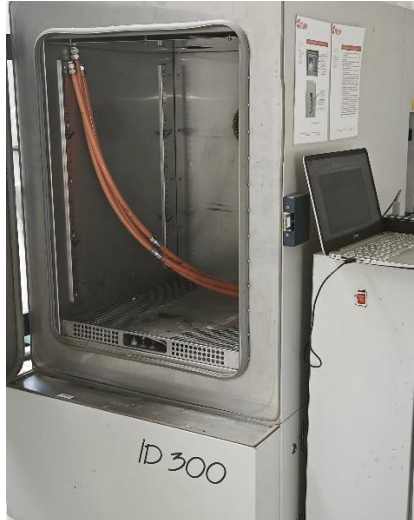
Şekil 1. Eklemlerin basınç çevrimine direnci deneyi sistemi
